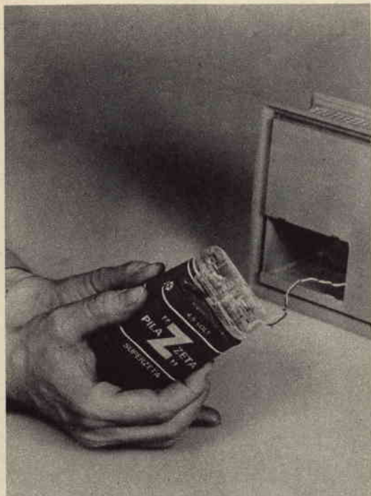
Fig. 9 - Le due pile, da 4,5 V., vengono inserite in una speciale presa polarizzata di plastica, sulla quale sono riportati i dati per l'esatto inserimento delle due lamine di ciascuna batteria.
