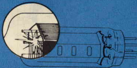
Fig. 15 - Internamente alla valvola possono verificarsi dei falsi contatti tra gli elettrodi, con manifestazioni di scintille ben visibili dentro l'ampolla di vetro.
