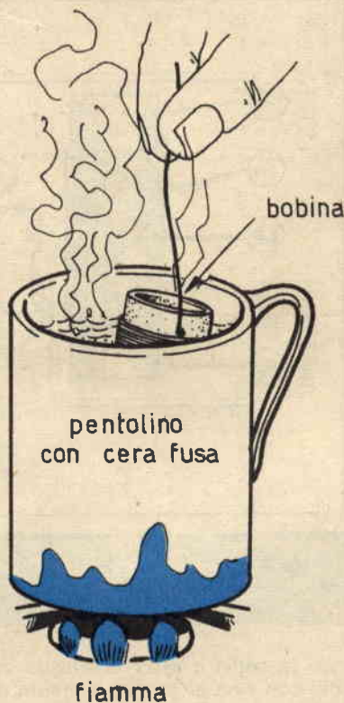
Fig. 6 - Il rivestimento con cera della bobina di sintonia protegge il componente dall'umidità e dagli altri agenti esterni.
